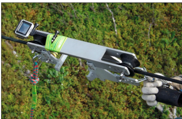
Рис. 2. Колесная система для перемещения по проводам/грозотросам устройства видеofиксации
